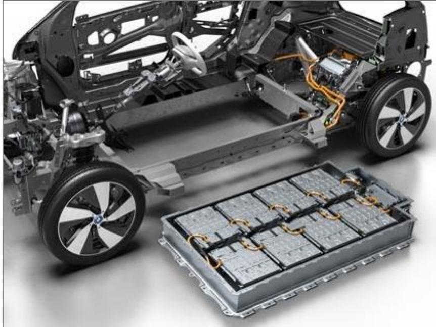
Die stoßempfindliche Batterie muss sorgfältig vor Beschädigungen beim Crash geschützt werden. BMW setzt die Batterie in ein stabiles Gehäuse, welches seinerseits von einem stabilen Rahmen umgeben ist. Die Anordnung im Fahrzeug möglichst tief ergibt einen tiefen Schwerpunkt und ein ausgezeichnetes Fahrverhalten ohne große Wankbewegungen.
