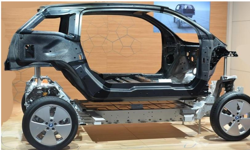
Ein Rahmen aus Aluminium mit großen Profilquerschnitten bietet die nötige Steifigkeit für das Fahrwerk. Darauf aufgesetzt ist eine ultraleichte Fahrgastzelle aus Carbonfasern. Im Prinzip klassischer Konzeptleichtbau in Vollendung. Nur leider im i3 am falschen Platz.
