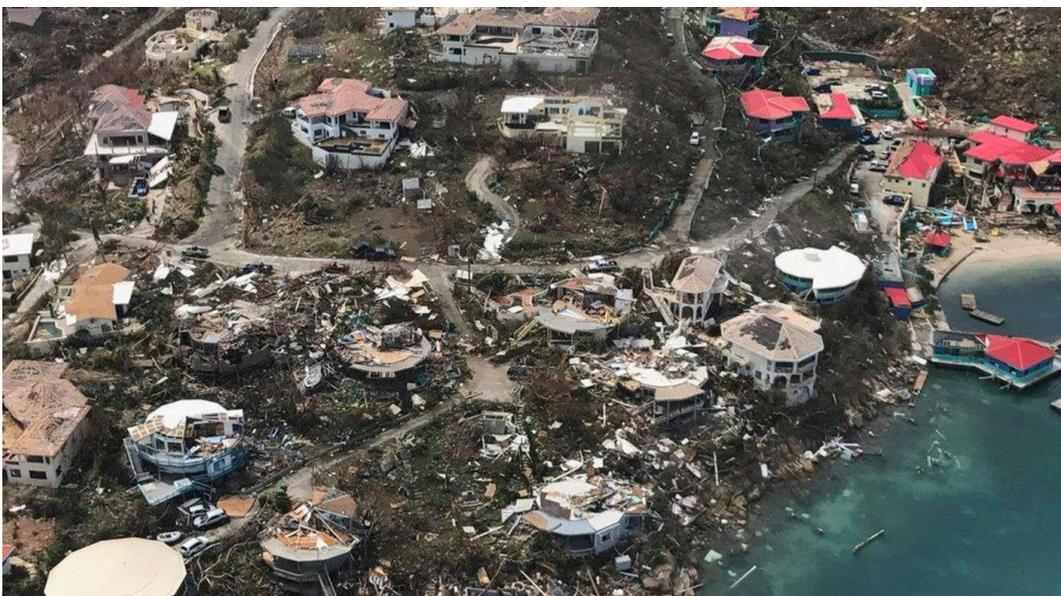
Geht halt nichts über einen einfachen, rechteckigen Baukörper, ohne gekünstelte Vor-, Rück- und sonstige Sprünge, mit wenig oder gar keinem Dachüberstand, um dem Wind möglichst wenig Angriffsfläche zu bieten. Material: Ziegel oder Beton.
