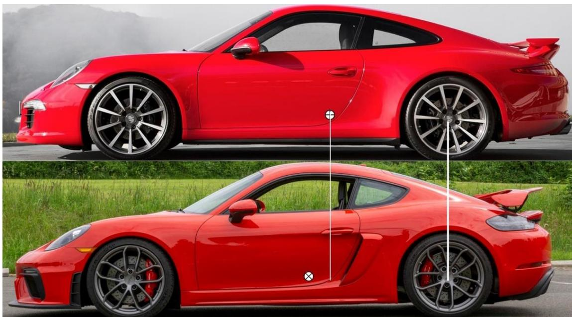
Der Cayman mit dem Motor vor der Hinterachse hat den Schwerpunkt am rechten Fleck für ein optimal abgestimmtes Fahrverhalten. Dazu noch ein um 115 Kilogramm niedrigeres Gewicht – was will man mehr.
