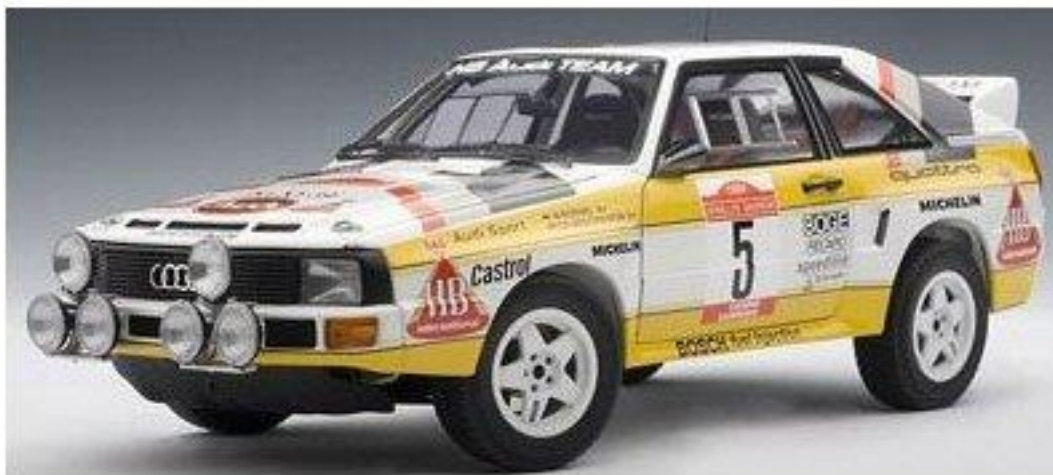
Audi Kurz-Quattro von 1984, Allrad, Frontmotor, Turbolader, 306 PS, 1300 kg
