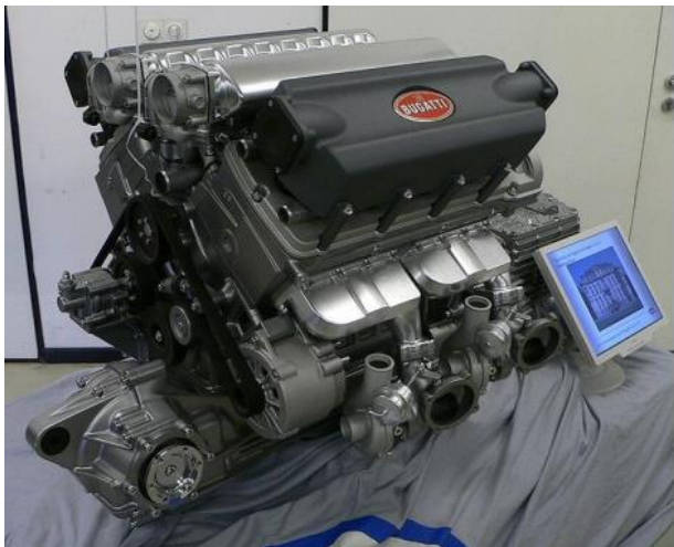
W16 Motor des Bugatti Veyron mit vier Turboladern.
