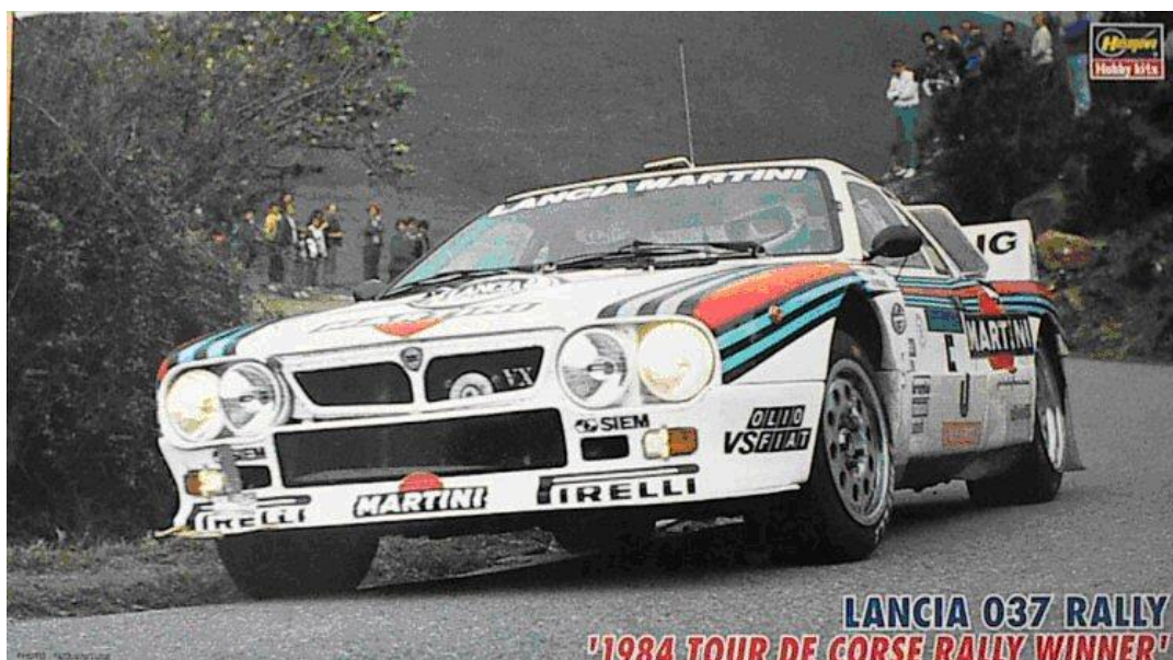
Lancia 037 Rally, Heckantrieb, Mittelmotor, Roots Kompressor, 310 PS, 1000 kg
