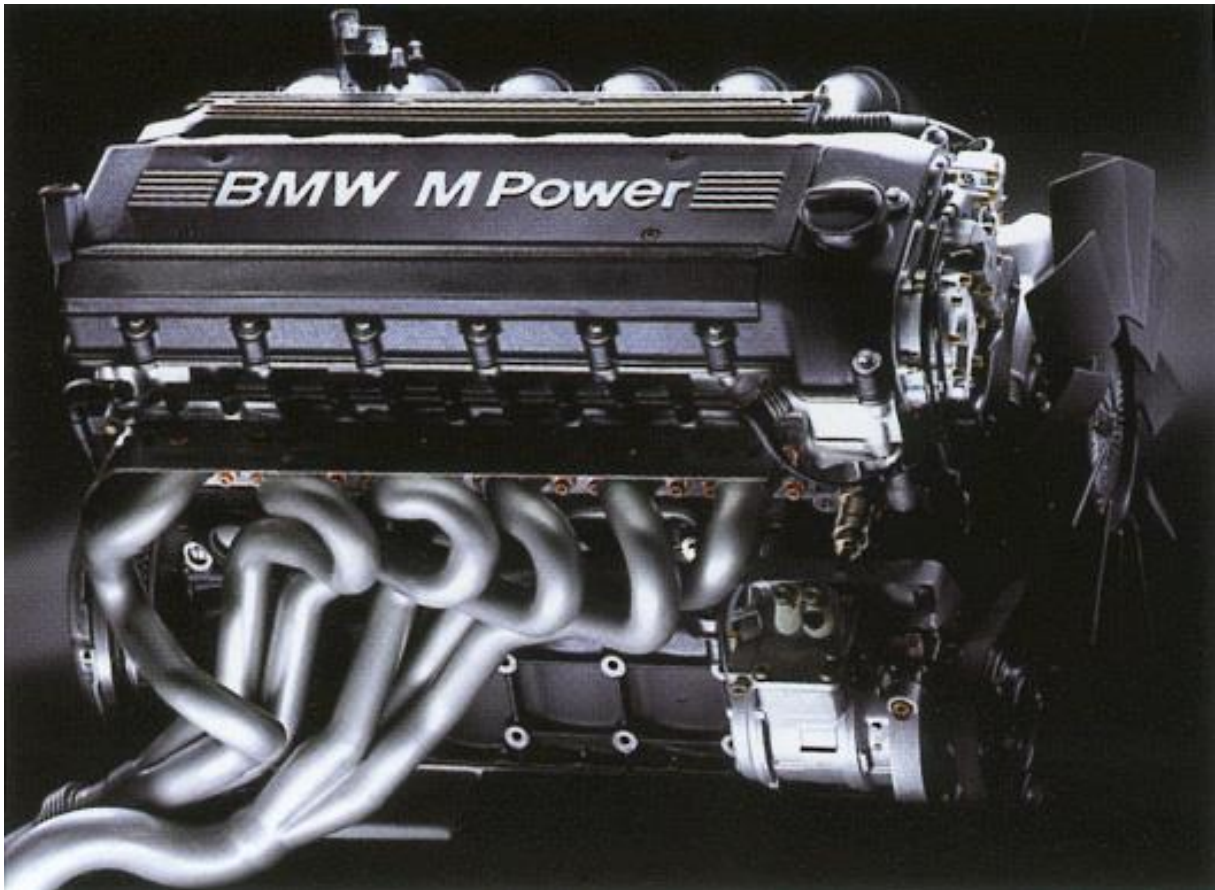
BMW Sechszylinder Saugmotor des M3. 3,2 Liter Hubraum, 321 PS bei 7400 U/min
